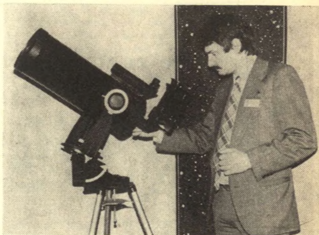
Jaromír Holubec z Přerova se svým přístrojem Makutov-Cassegrain ( \varnothing 163 mm, f = 2080 ) na paralaktické vidlicové montáži s ručním pohonem při nasazování videokamery. Foto: Jaroslav Drahoukoupil
