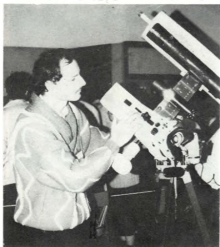
Konstruktér M. Herna u svého přístroje Newton s pointem, \varnothing objektivu 160, 60 Sonet Binar, f = 660, 650, 12 \times 60 . Parakt. montáž něm. typu s elektrickým pohonem.
