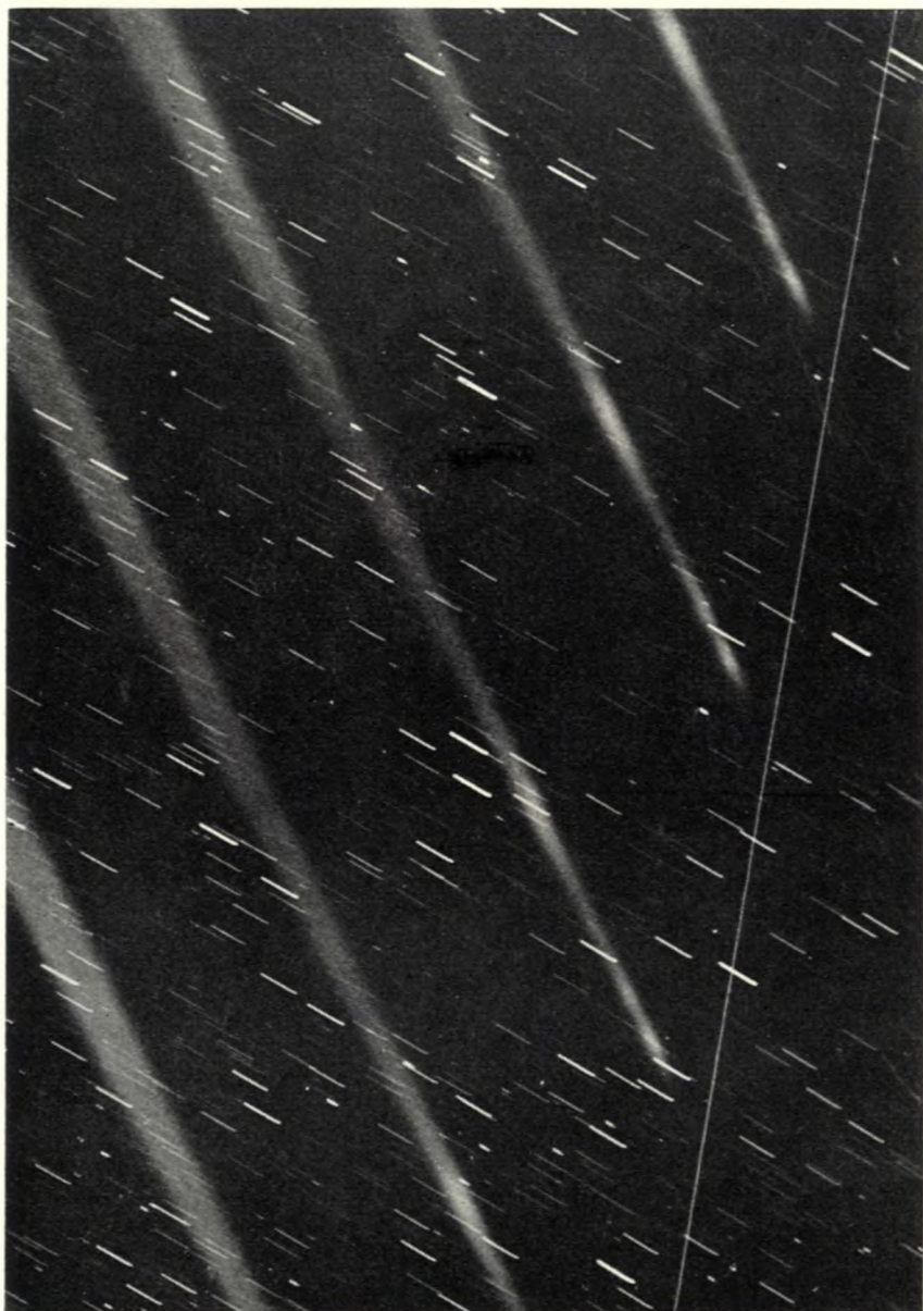
Fotografie ze simultánního laserového a fotografického pozorování družice Interkosmos 17 ze dne 6. 8. 1978. Světlé pásy směřující ke stopě družice jsou rozptýleným světlem laserového dálkoměru. Schmidtova komora 420/600/1000 mm v Hradci Králové.
