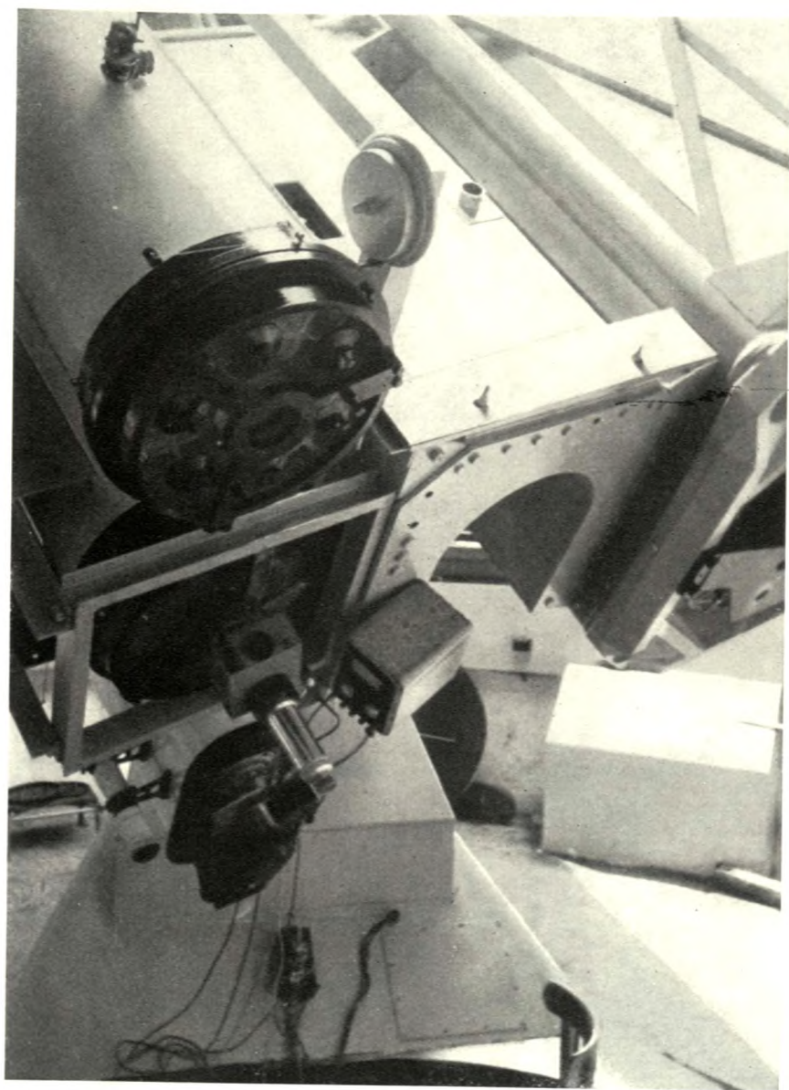
Maksutovova komora a fotoelektrický fotometr dalekohledu na Kleti. — Na čtvrté str. obálky je pohled na vrchol Kletě s hvězdárnou, televizním vysílačem a starou Schwarzenberskou rozhlednou.
