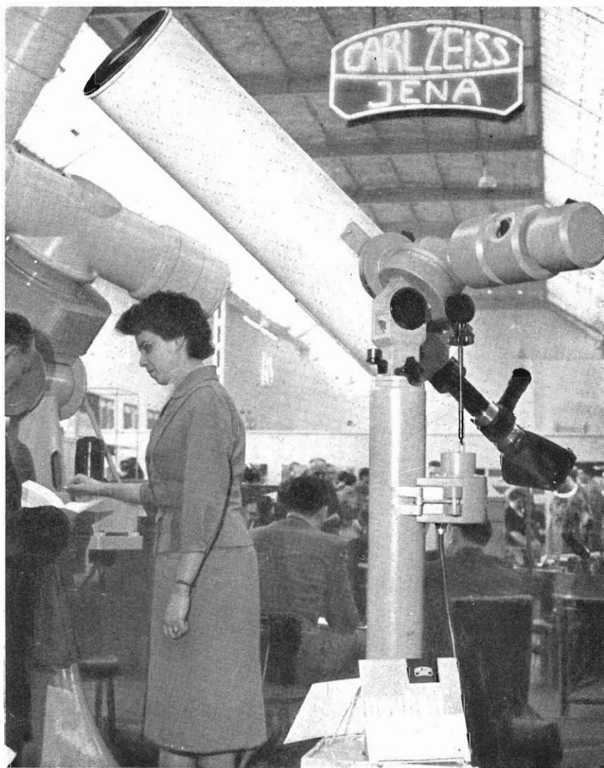
Na veletrhu v Lipsku vystavoval VEB Carl Zeiss Jena amatérský Cassegrainův zrcadlový dalekohled s ohniskovou vzdáleností 225 cm, opatřený komorou na fotografování Měsíce a planet. — Na čtvrté straně obálky prstencová planetární mlhovina v souhvězdí Lyr (NGC 6720).
