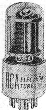
Vlevo obr. 1. Fotoelektrický násobič typu 931-A-RCA. Vpravo obr. 2. Nejjednodušší schéma zapojení fotonásobiče s jednostupňovým zesilovačem. A značí zdroj anodového napětí pro fotonásobič, které se přivádí na katodu a jednotlivé dynody přes dělič napětí D. Do obvodu jednostupňového zesilovače je zapojen citlivý galvanometr G. Anodový proud dodávaný zdrojem A', je kompenzován částečně pomocí zdroje C, aby tak výchylka galvanometru byla ve vhodných mezích (je tím možno kompenzovat i temný proud). Hodnoty naznačených odporů je nutno volit podle charakteristiky a vlastností elektronky.
