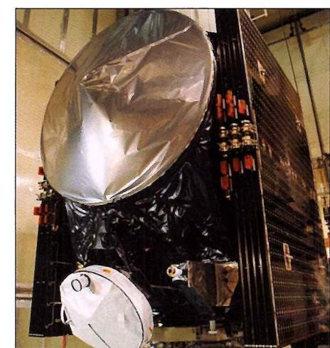
Obr. 8. Sonda Dawn pred vložením do startovej kapsuly, vpravo poskladané slnečné panely.
