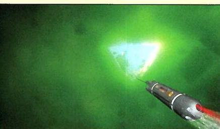
Ilustrácia miniponorky DADU (Deeper Access, Deeper Understanding), ktorú vyvinuli v rámci spolupráce medzi Jet Propulsion Laboratory (NASA) a univerzitou v Uppsale, Švédsko. Ponorka má rozmer výšky veľkej plechovky.
