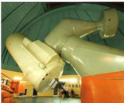
Dvojmetrový ďalekohľad typu Ritchey-Chrétien: priemer hlavného zrkadla 2 m, sekundárneho 0,6 m, RC ohnisko 16 m, coudé ohnisko 72 m (spektrograf).
