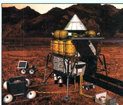
Nákladná loď, vyslaná 2 roky pred štartom lode s posádkou, dopraví na Mars všetok užitočný náklad. Tento nákladný pristávací modul bude automatickou chemickou fabrikou, ktorá z dovezencích surovín a martanskej atmosféry dokáže vyrobíť palivo pre lod (MAV), ktorá dopraví marsonautov na Zem.
