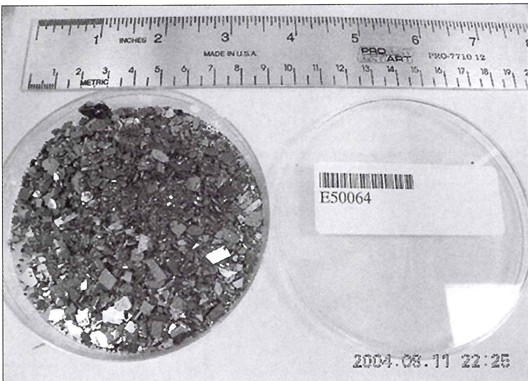
Obr. 6: Toto sú kúsky zo sústavy lapačov (kolektorov) získané z návratového modulu. Napriek tomu je výskumný tím stále optimistický a tvrdí, že bude schopný obnoviť takmer všetky vzorky so zachytenými čiastočkami slnečného vetra.
