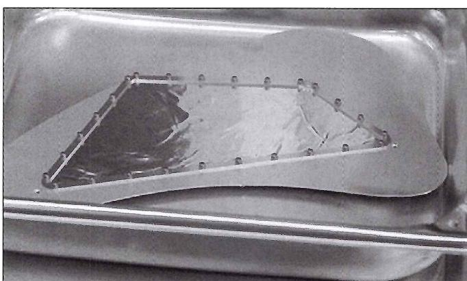
Obr. 4: Prakticky nepoškodená ostala zlatá fólia, jej úlohou bolo zaznamenať izotopy dusíka. Bola v poradí druhým najdôležitejším experimentom na palube návratového modulu.
