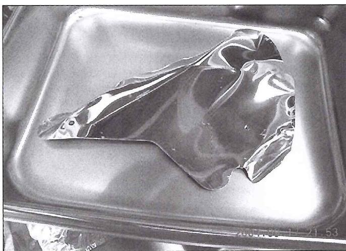
Obr. 5: Tento lapač mal zachytávať hlavne vzácné plyny a ich izotopy. Naďalej tomu, že je poohýbaný, podarilo sa ho úplne obnoviť.
