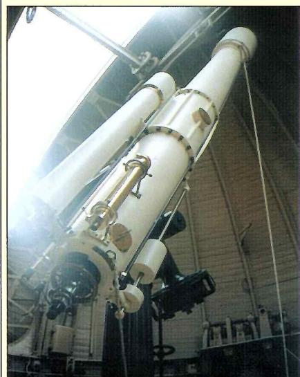
Veľká kupola – najväčší dalekohľad je refraktor 214/5000 mm od firmy Carl Bamberg Instruments Berlin z roku 1889 (objektív je už vymenený), menší dalekohľad je refraktor Rheinfelder und Hertel 150/2250 mm, v mosadznom tubuse je originálny hľadáčik firmy Bamberg.
