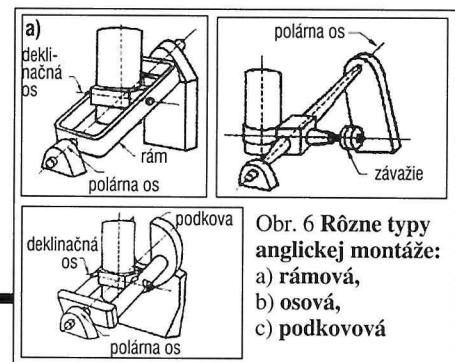
Obr. 6 Rôzne typy anglickej montáže:
