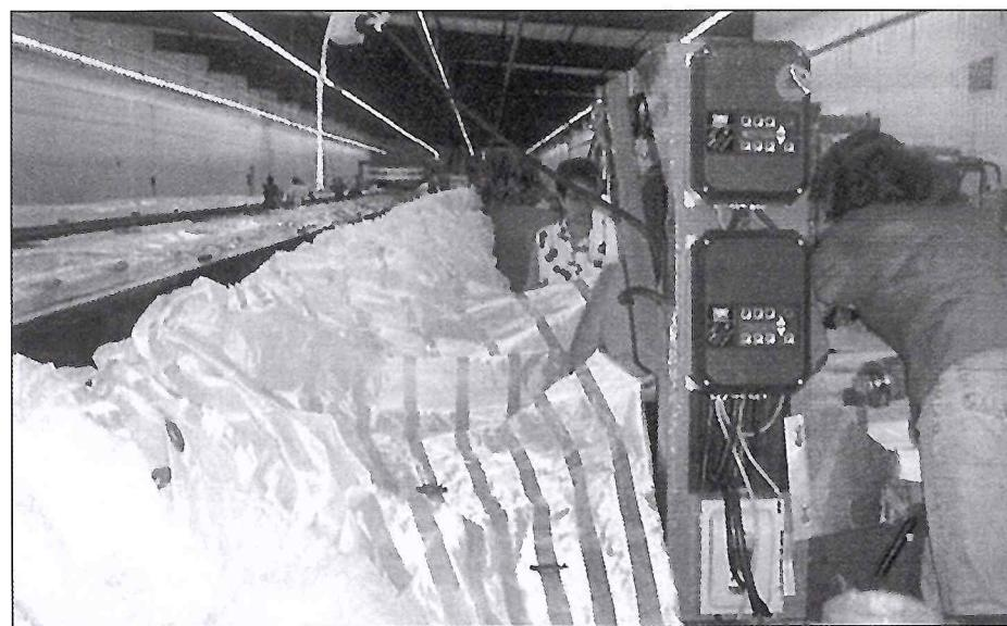
Obálku ULDB balónov tvorí sendvič troch komponentov: tkanina z polyestera zabezbečuje pevnosť; blana z polyestera neprepustí ani molekulu hélia; blana z polyetylénu je v príamom kontakte s plynom a navyše zvyšuje pevnosť obálky. Na spodnej snímke vidíte malý model ULDB balóna, ktorý vyskúšali koncom minulého roku. So štartom veľkého ULDB sa počíta v roku 2001.
