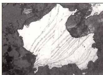
**Kamacit po leptaní nitalom vytvára prúžky – Neumannove obrazce – ktoré svojím tvarom nasvedčujú deformácii v plastickom stave.**
