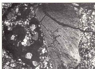
**Fragment chondruly radiálneho enstatitu a kráterová štruktúra (na pravom okraji) nasvedčujú neskoršej deformácii už pevnej chondruly.**
