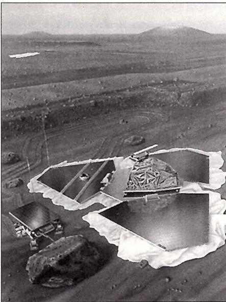
**MESUR** bude pravou zo série „lacných“ misí typu Discovery, ktoré v budúcom desaťročí NASA uskutoční. Cielom predbežne jediného modulu (pôvodne ich malo byť 8-12) bude Mars. Na ilustrácii vidíte jeden z modulov MESUR/Pathfinder, vybavený kamery, röntgenovým spektrometrom, seismografom a prístrojmi na prieskum atmosféry. Vľavo od modulu je rover, mikrovodzidlo, ktoré sa v okolí sondy bude pohybovať rýchlosťou meter za sekundu.
