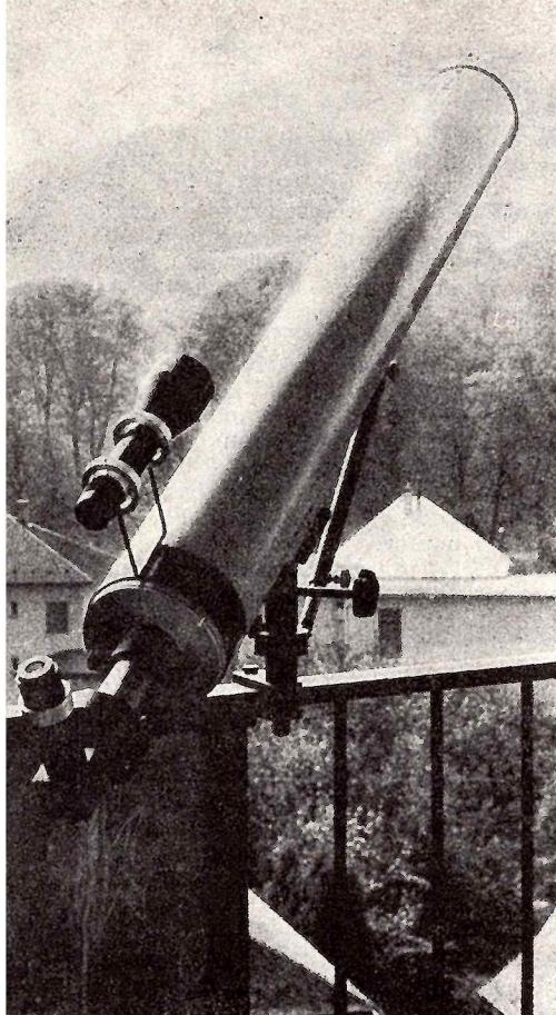
Obr. 2 — Refraktor  $\varnothing 130$  mm,  $f = 1500$  mm na montáži s pístovým držákem tubusu
