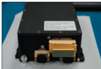
Letový exemplář tříosého MEMS gyroskopu mise Proba-3
