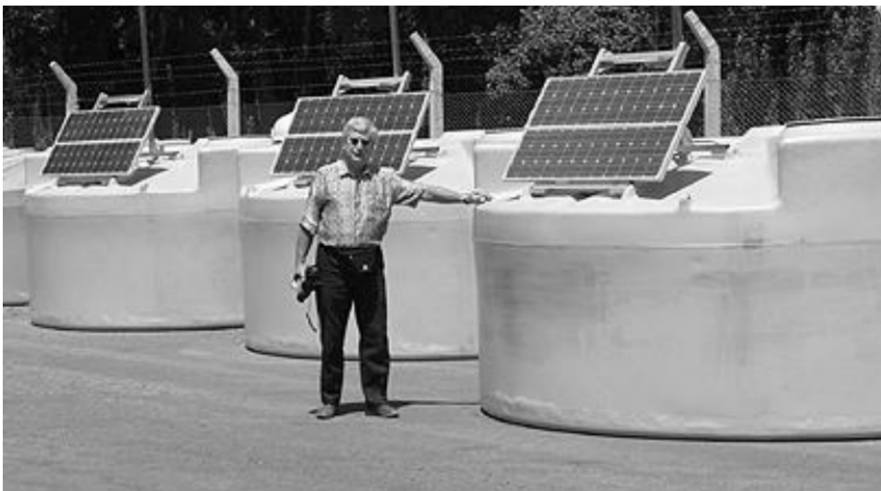
Pozemní detektory Čerenkovova záření připravené k rozvozu do pampy. Každý detektor obsahuje 12 m 3 destilované vody, tři fotonásobiče, řídicí počítač, napájení slunečním panelem a anténu pro mikrovlnné spojení s centrálním počítačem. Nesmí mít na sobě žádné výstupky, jelikož argentinské krávy je začaly používat jako drbátko. (foto M. Hrabovský)
