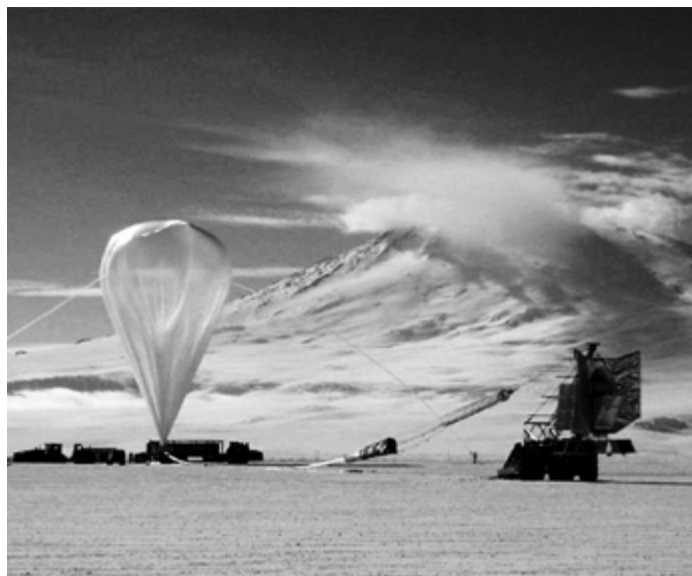
↑ BOOMERANG. LDB balón (nalevo), který vynesl radioteleskop (napravo). V pozadí hora Mt. Erebus.
