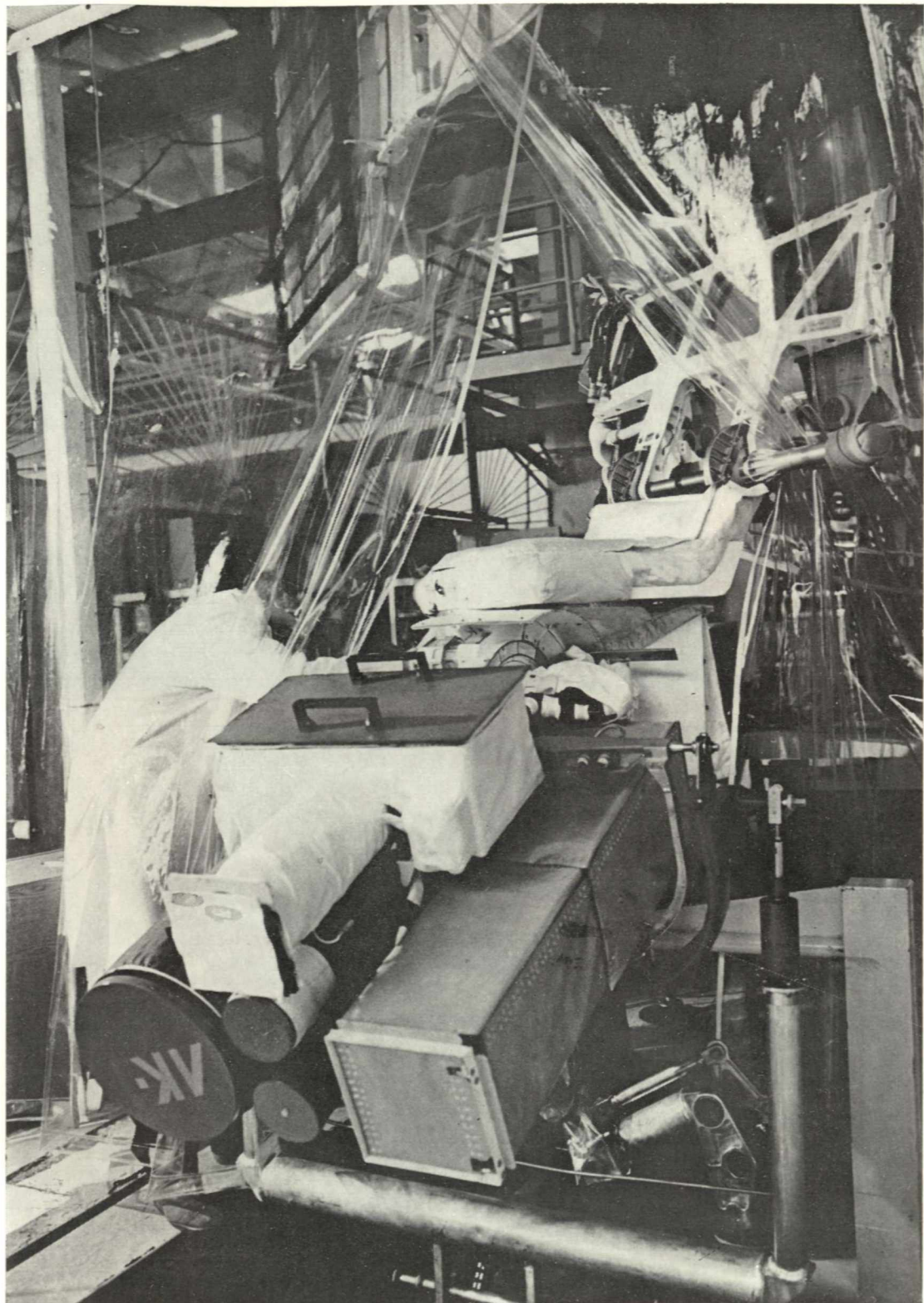
Konečná montáž plošiny se všemi přístroji na sondu probíhala pod igelitovým „stanem“ (Ke zprávě na str. 78.)
