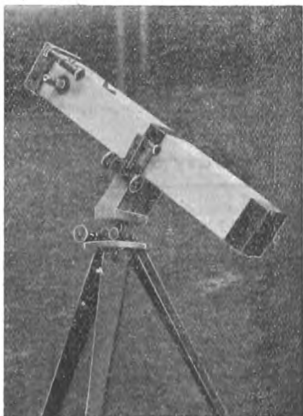
Newtonův reflektor \varnothing 120 mm, f = 100 cm. Postavil J. Stančík.
