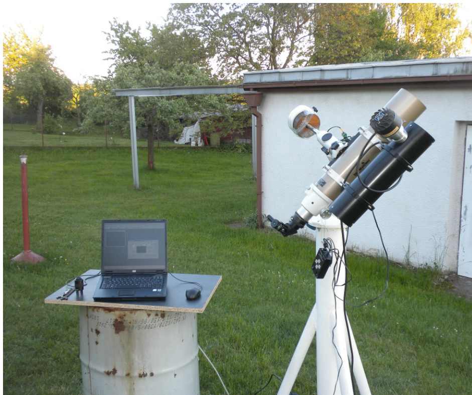
Obr. 7 — Nová sestava CG-4 + ED 80 + reflektor 0,096 m f/4,4 + CCD ST-5C + BVRcIc.
