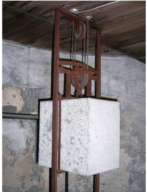
Obr. 12 — Hodinový stroj a závaží pod podlahou.
