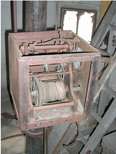
Obr. 12 — Hodinový stroj a závaží pod podlahou.
