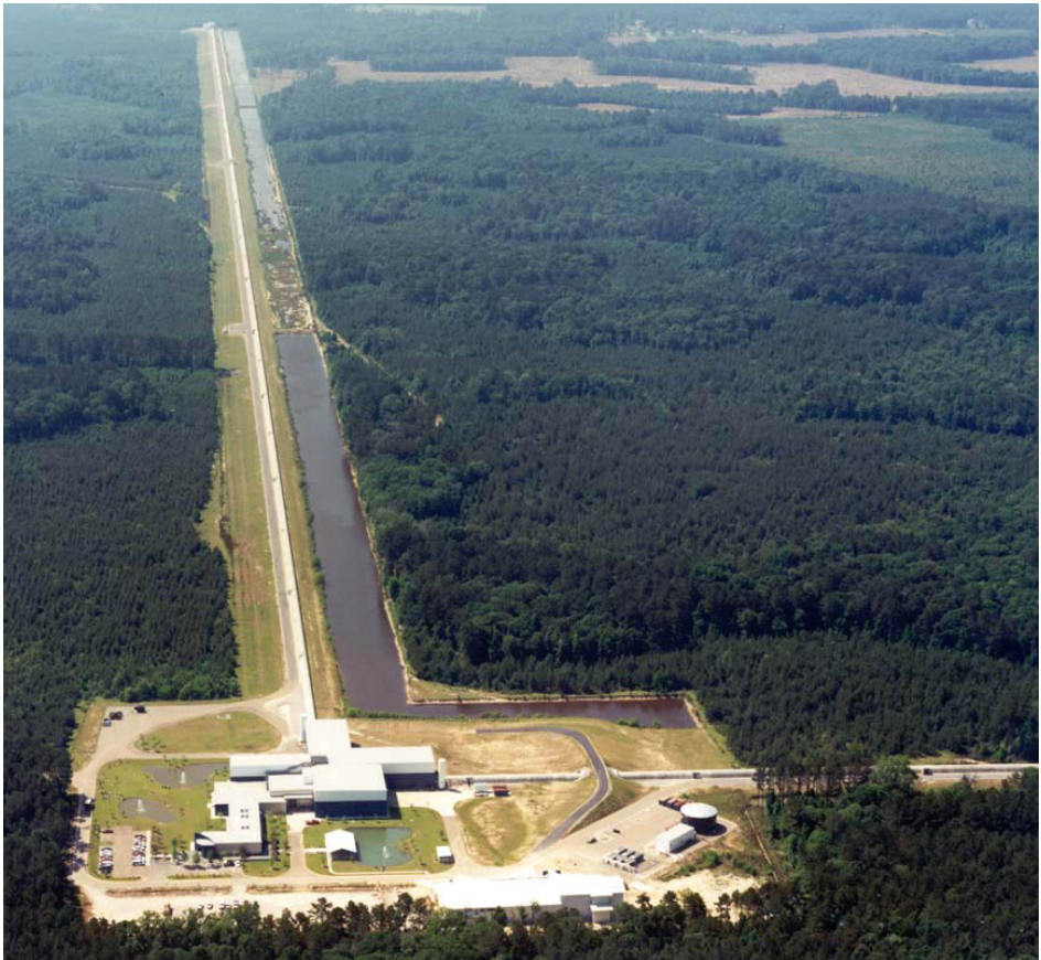
Obr. 13 — Letecký pohled na detektor gravitačních vln LIGO Livingston Observatory, resp. jeden ze 4 km tunelů s interferometrem. Převzato z [2].
