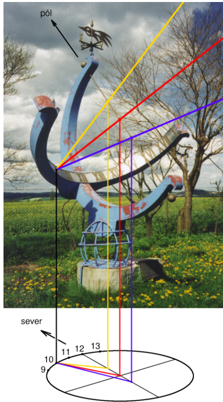
Obr. 3 — Polární prstencové sluneční hodiny a jejich průmět do vodorovné roviny. (Jedná se o hodiny u hvězdárny ve Vlašimi. Foto Jan Trebichavský (1997).)
