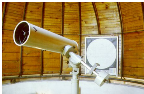
Obr. 11 — (a) S. Štefeček a M. Brož před hvězdárnou v Sobotišti; (b) Cassegrain 150/2250 v místní kopuli.
