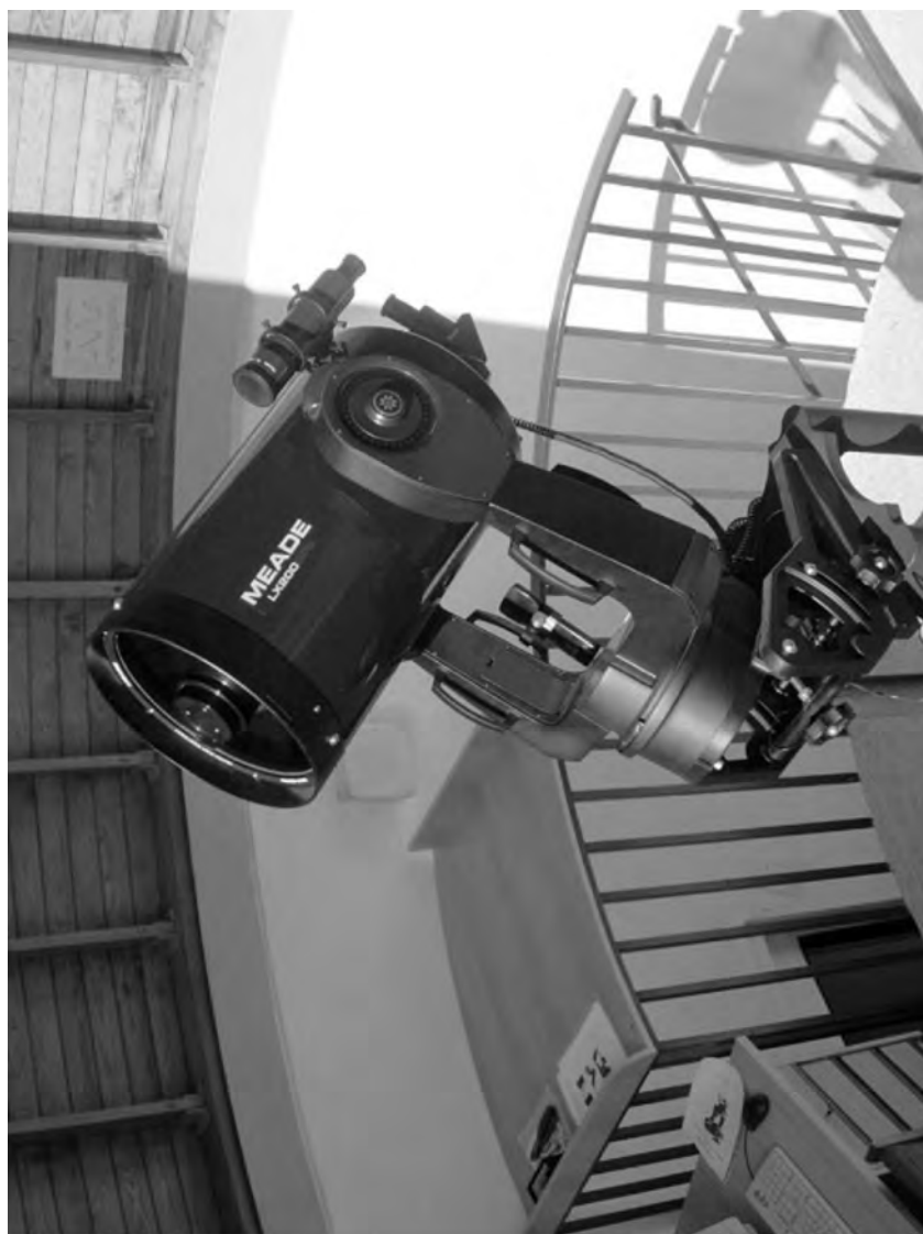
Katadioptrický systém Schmidt-Cassegrain firmy Meade o průměru primárního zrcadla 305 mm
