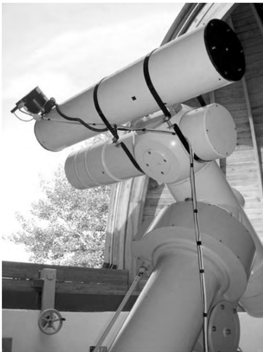
Zrcadlový dalekohled typu Newton o průměru zrcadla 200 mm
